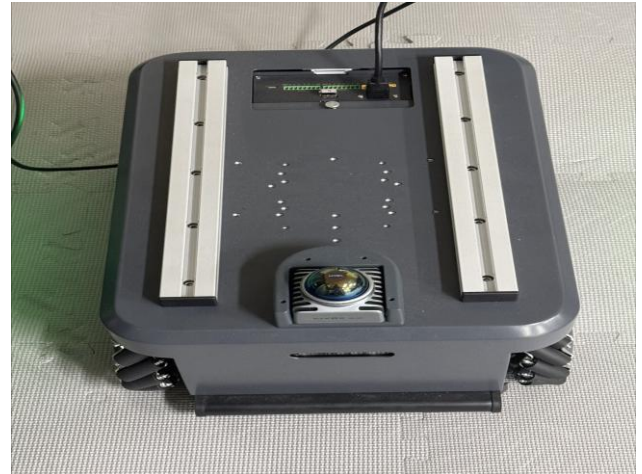
그림 1. 3D LiDAR 센서가 탑재된 이동 로봇 플랫폼 외관
